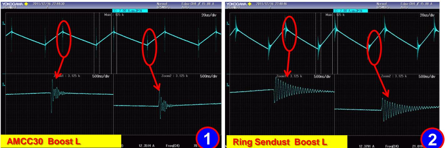
①图所示，使用AMCC30磁芯进行绕制，输出功率为3KW的Boost电路的实测DCL电流波形（20KHz）；
